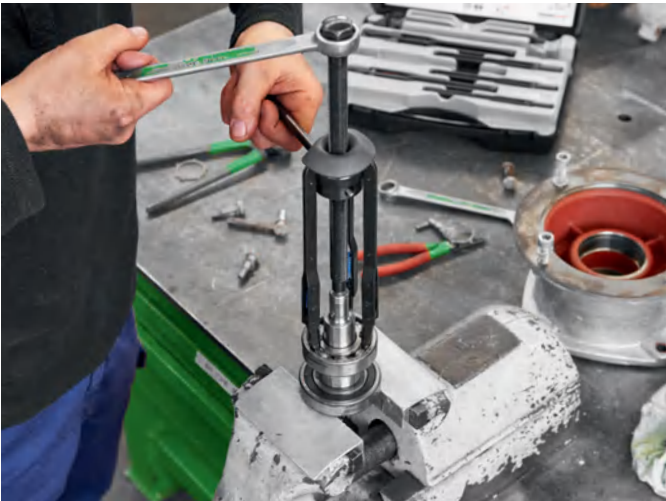
轴承拆卸器BP 61可确保球轴承从轴上被轻松且可控的拆卸
