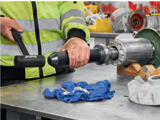
拆装工具FT 33保证安装应力被均匀施加在轴承内外圈上，避免被施加在滚动体上
