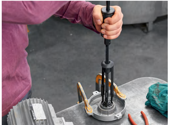
维护箱MK 10-30使得球轴承可以轻松从电动机端盖上被拆卸
