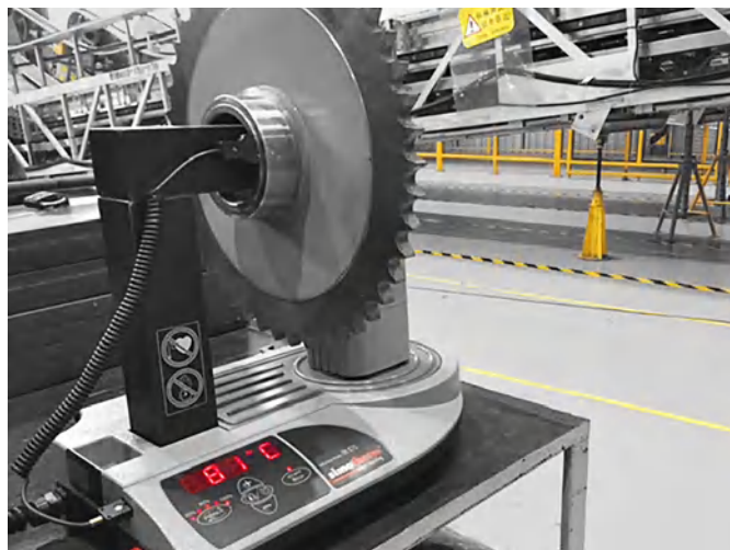
电磁感应加热器IH 070是用于电动扶梯的梯级链轮加热的理想选择
