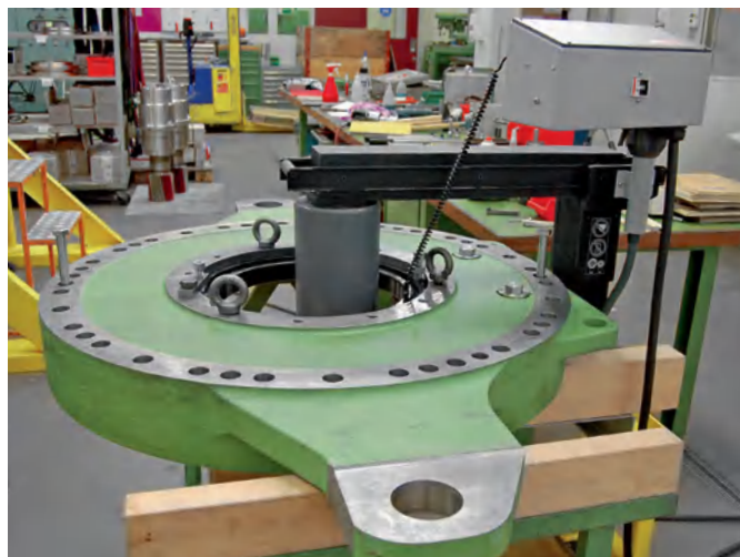
最大和最高效的司马电磁感应加热器IH 240被用于风力发电机齿轮箱法兰的加热。
