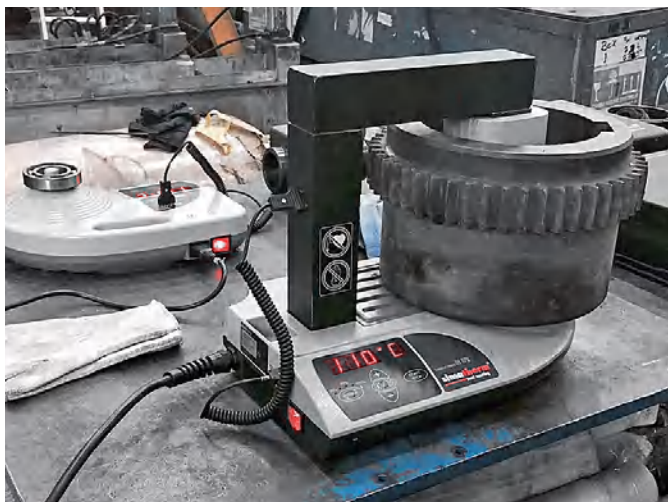
司马电磁感应加热器VOLCANO IH070和IH070加热两种不同尺寸的工件：型号IH070（前方）加热一个齿轮套到特定的安装温度。
